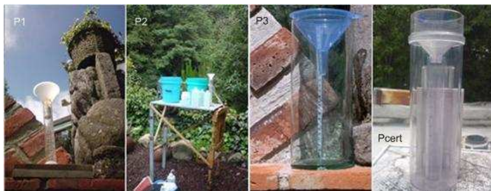
Figura 4.7. Pluviómetros de fabricación casera y pluviómetro certificado marca Productive Alternatives Inc.
